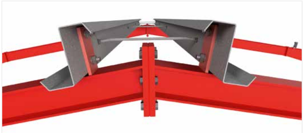
Schlaudern- verbindung in den Firstpfetten
