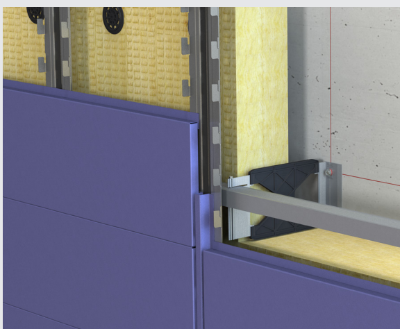
Wärmebrückenfreie Unterkonstruktion, Fox HT (Brandschutzvorschriften sind zu beachten)
