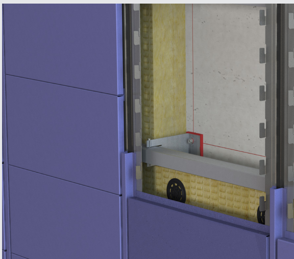
Mehrlagige Unterkonstruktion: System horizontal/vertikal
